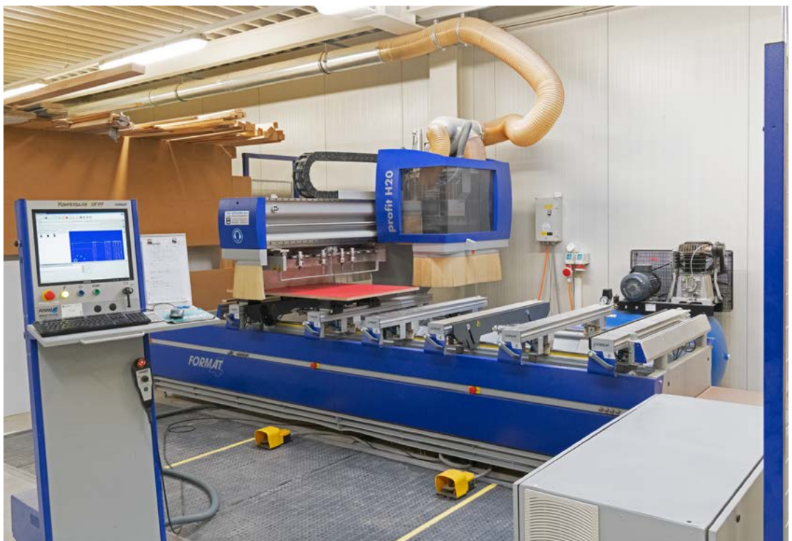
Diese CNC-gesteuerte Maschine dient dem Zuschnitt der Elemente zum Möbelbau wie Küchenmöbel, Schränke, Gestelle, Tablare etc. Sie kann auch die Kanten bearbeiten und Löcher für die Scharnier-Aufnahme bohren. Ohne eine solche Maschine ist Möbelbau nicht mehr wirtschaftlich zu betreiben.
