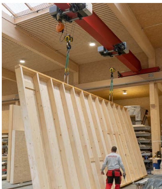
Zwei Kranbalken mit je zwei Laufkatzen ermöglichen das mühelose Heben von grossen Bauteilen wie hier die Decke eines der Kindergartenpavillons.
