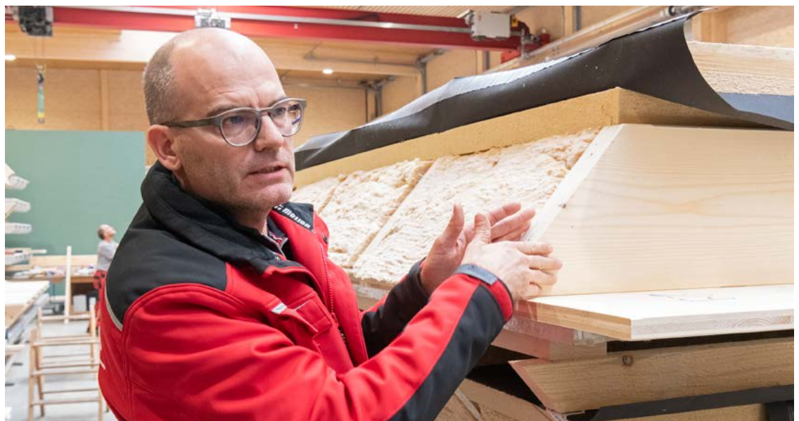
Marco Baumberger erklärt den Aufbau der Wände mit der Isolation.
