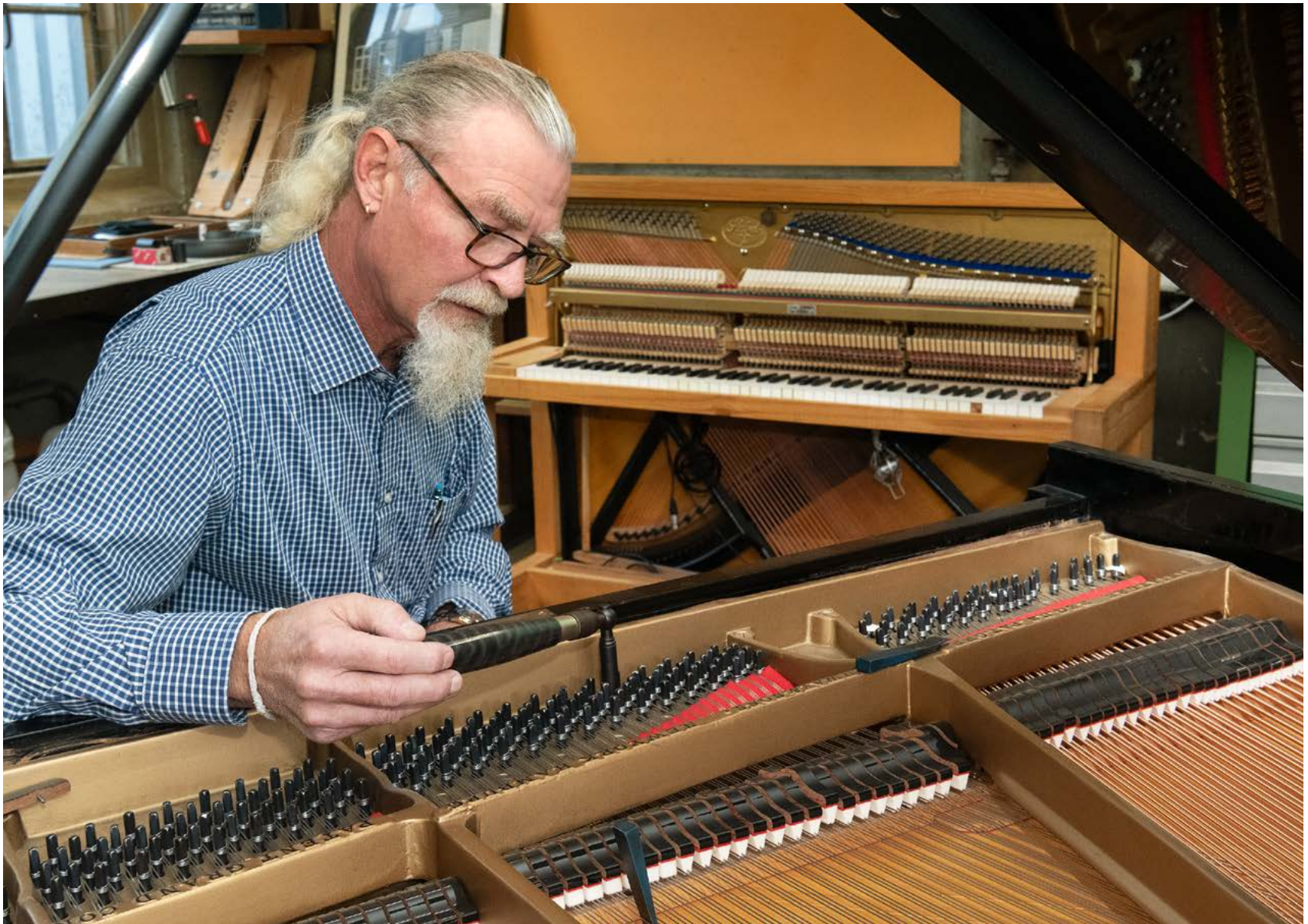
Stefan Billeter stimmt einen Flügel. Mit dem Stimmhammer formt er nach Gehör den Klang der Saite.
