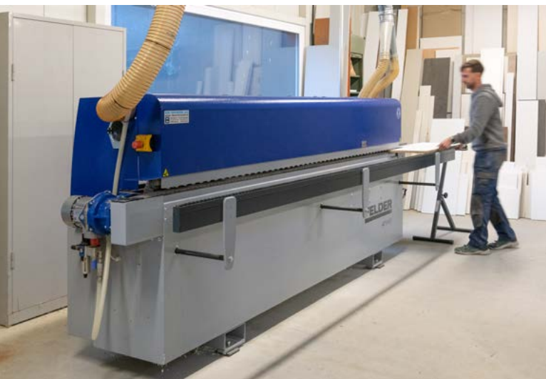
Mit dieser Maschine werden die Möbelemente mit einer Kante versehen.
