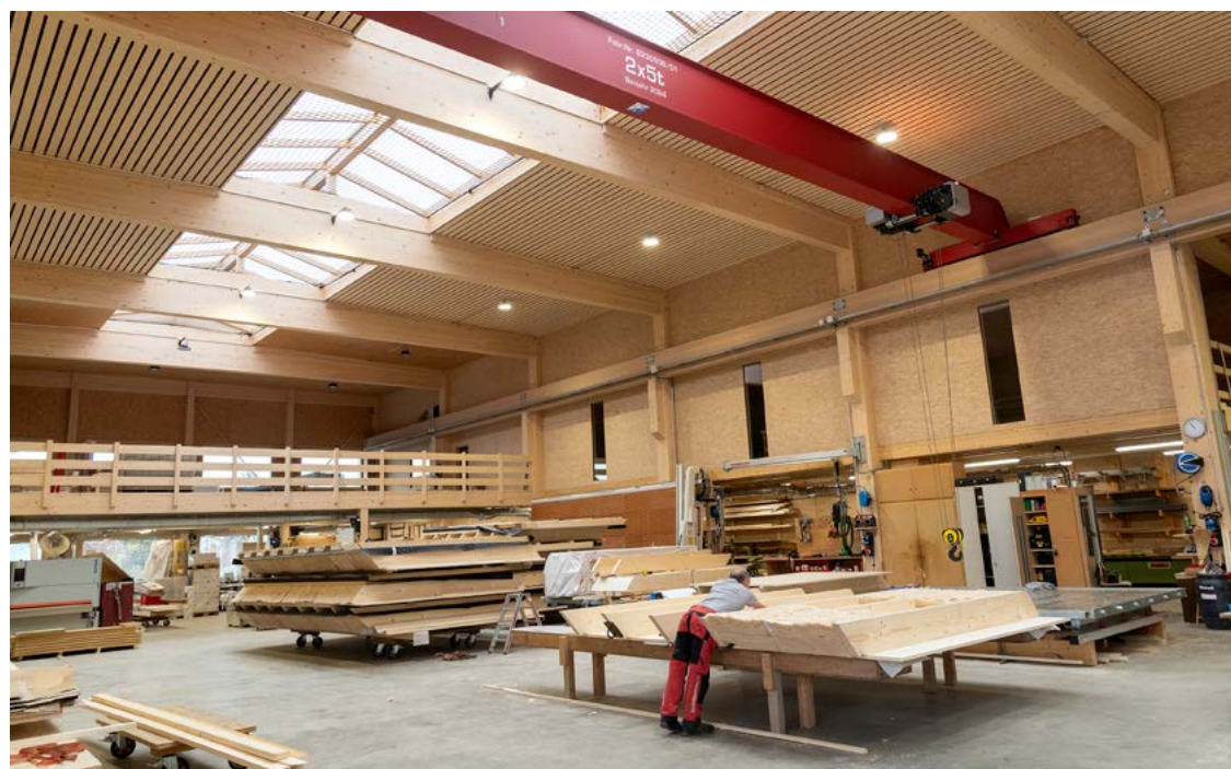
Die riesige Produktionshalle erlaubt die Herstellung und den Zusammenbau grosser Bauteile.
